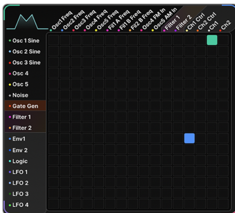
Figura 29: Matriz de Modulación — grid 16×16. Las filas son fuentes de modulación (Osc 1-5, Noise, Gate Gen, Filtros, Envs, LFOs, Logic). Las columnas son destinos (cualquier parámetro modulable vía clic derecho, más rutas de audio fijas para I/O de filtro/canal).
