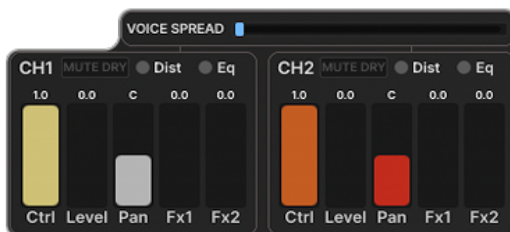
Figura 22: Canales 1 y 2 — strip de mezcla de salida con CTRL, Level, Pan, sends FX 1/2, más acceso a EQ y Distorsión por canal. Panel de Voice Spread a la derecha.
