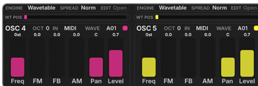
Figura 4: Osciladores 4 y 5 — layout multi-engine de wavetable. Cada uno muestra 6 faders (Freq, FM/PM, FB o engine-specific, AM/RM, Pan, Level) más selector Wave y slot de engine.
