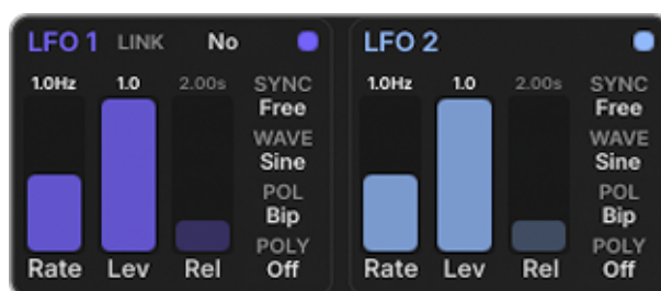
Figura 16: LFO 1 y LFO 2 — primer par, con rate, level, release, modo sync, waveform, polaridad y opciones poly.
