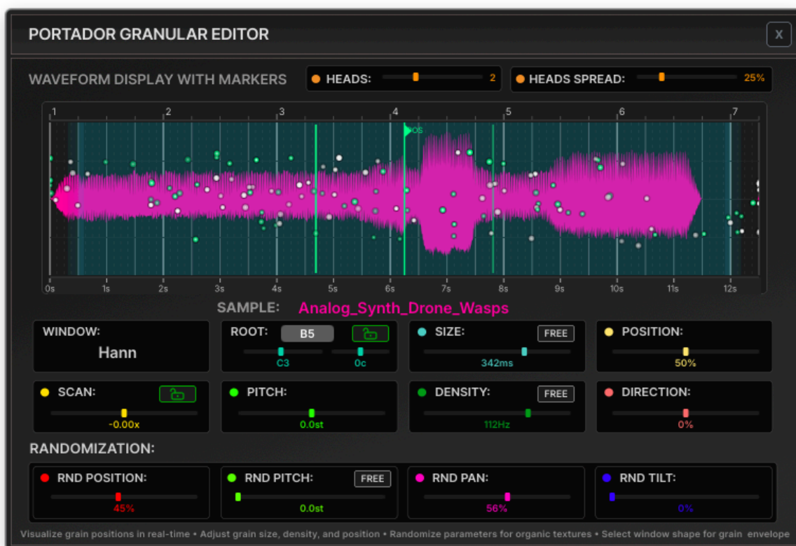
Figura 8: Editor Granular — visualización de waveform con controles de densidad de granos, tamaño, posición y cuantización de pitch.
