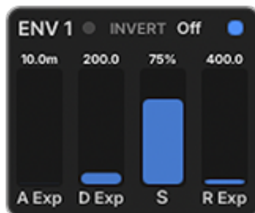
Figura 14: Envelope 1 — ADSR clásico con etapas de attack, decay, sustain y release más toggle de inversión.
