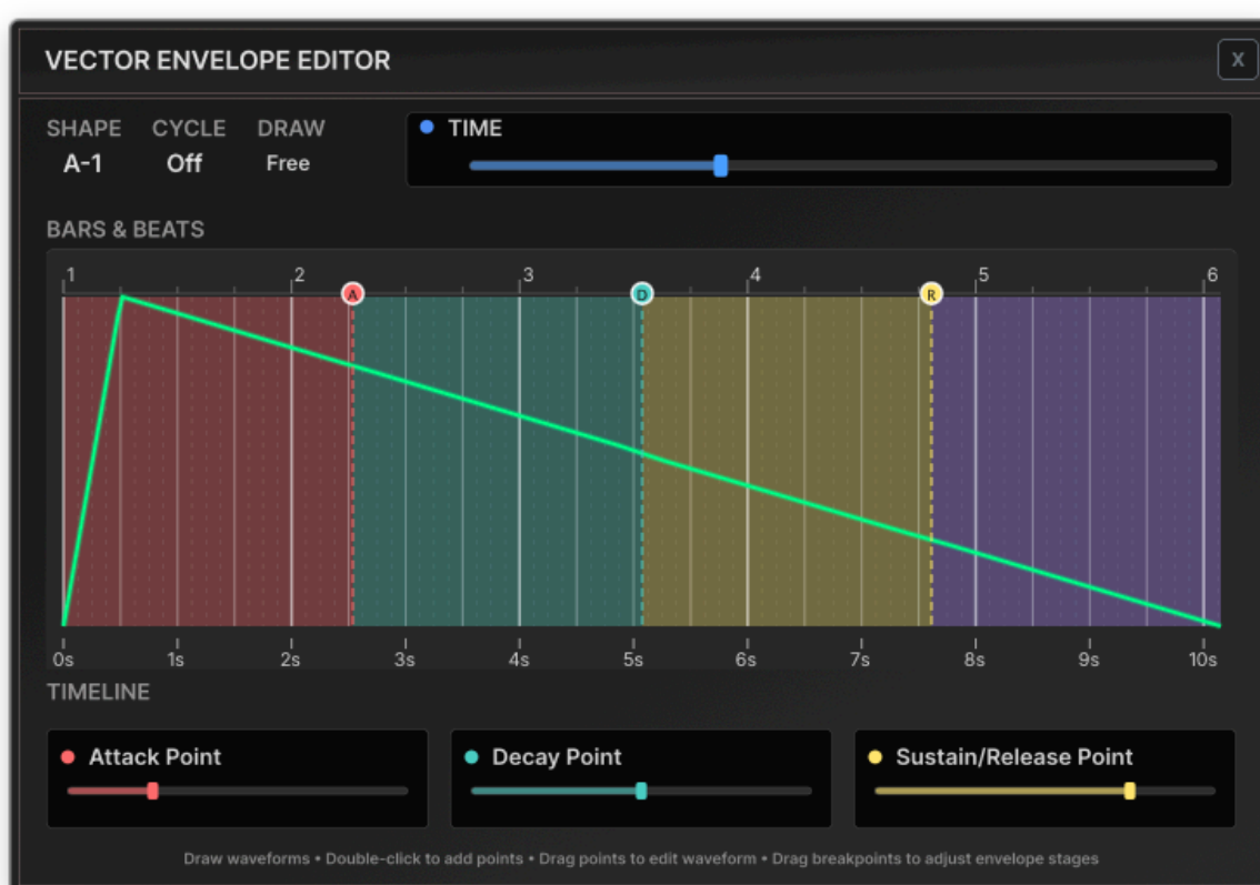
Figura 19: Editor VENV — editor visual de ondas vectoriales con controles de ganancia por sección, región de loop y selector de presets.
